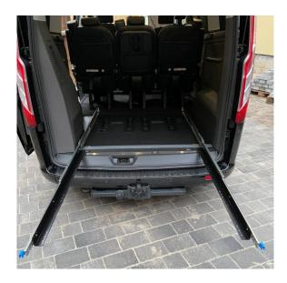
PVC-Unterlage unter den vorderen Winkel legen, damit wird bei Belastung ein Zerkratzen der hinteren Fahrzeugblende vermieden. Statt dieser Winkel wird der Bügel montiert. Dazu Slides voll ausziehen und hinten anheben. So kann mit der Schraube das Loch im Bügel erreicht werden!
