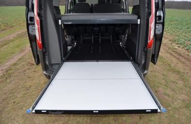
Den Auszug, im ausgezogenem Zustand nur mit maximal 180kg über die Fläche verteilt beladen.
