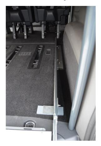
Auf die Herausgezogenen Winkelauflagen die beiden Bodenteile auflegen. Die Holzdübel einsetzen und die Bodenteile zusammenschieben. Anschließend die
