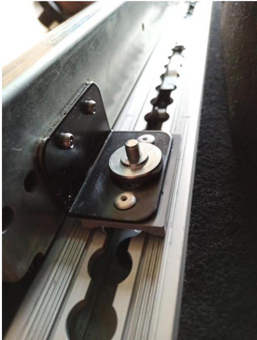
Wenn alle 4 Rändelmuttern aufgeschraubt sind, die Ausrichtung der Slides überprüfen. Da die Langlöcher der Haltewinkel etwas größer sind als die Schraube, kann der Slide leicht schief im Auto liegen. Er muss aber genau parallel zur Schiene verlaufen!
