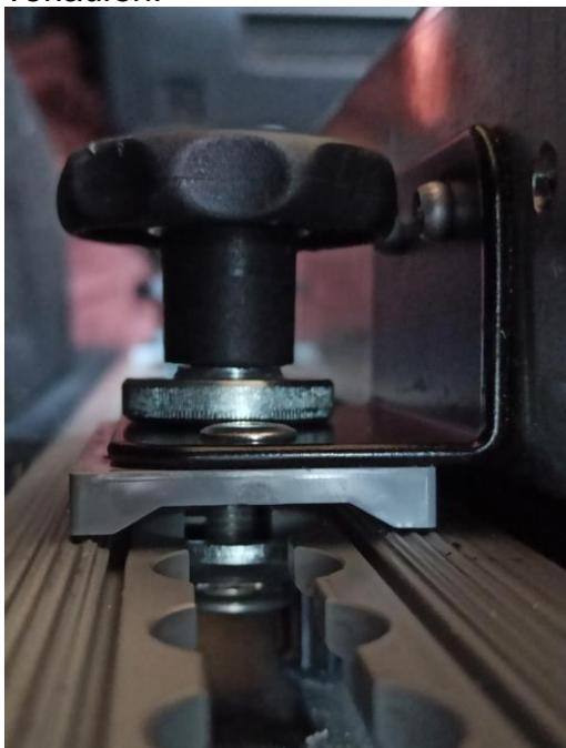
Abschließend alle Rändelmutter gut festziehen, den Sitz der Fittings prüfen und dann die Kontermutter handfest aufdrehen. Schieben sie jetzt den Heckauszug mehrfach bis hinter die Arretierungen aus und ein. Ggf. muss nun noch mal eine Halterung nachgezogen werden. Der Sitz der Fittings sollte nach bzw. während des ersten Einsatzes und dann regelmäßig in geeigneten Abständen geprüft werden.
